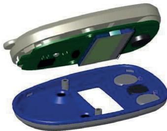
3. Obě baterie umístěné v otvoru v gumovém těsnění nahradte novými, a to bateriemi CR1632 nebo ekvivalentními 3V lithiovými knoflíkovými bateriemi. Dbejte na správnou polaritu! Kladný pól (+) musí směřovat dovnitř otvoru v gumovém těsnění. Ujistěte se, že jsou na svém místě dvě malé pružinky, které zajišťují kontakt mezi (+) pólem baterie a destičkou s tištěnými spoji.
