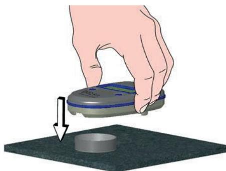
Správně usazenou misku poznáte tak, že Pawkit (položený na misce a nožičkách otevřeného krytu) je rovně s podložkou. Ujistěte se, že miska opravdu zcela zapadla do vybrání. V opačném případě nebude sedět rovně na podložce a miska nebude utěsněna v měřicí komoře.
