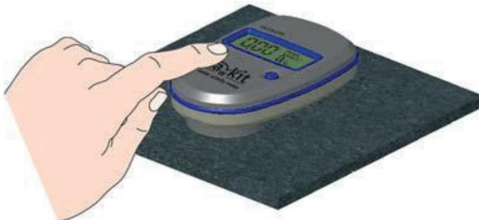
Měření vodní aktivity zahájíte stiskem tlačítka **I**. Na displeji se vynuluje předchozí naměřená hodnota a zobrazí se  $0.00a_w$
